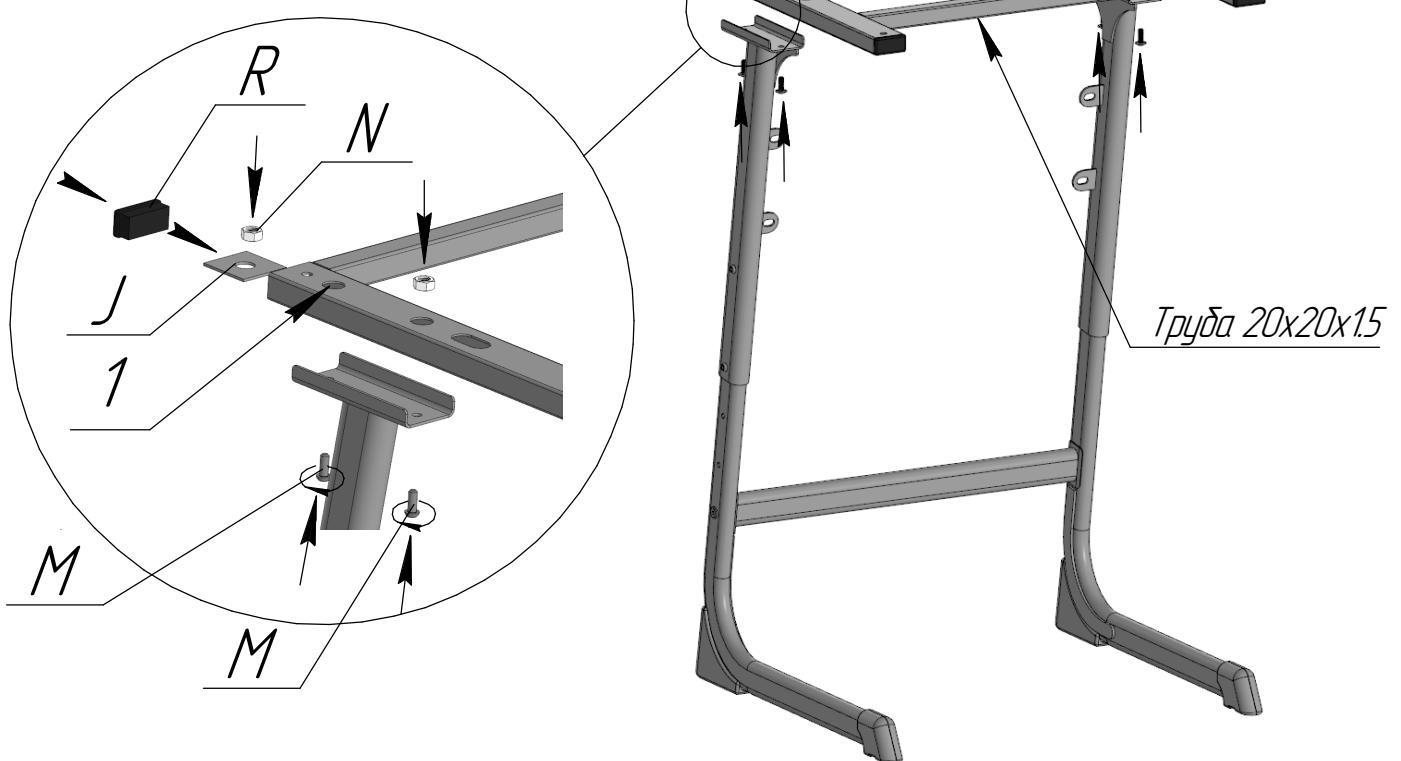
Пластину J установить внутрь трубы, совместив отверстие в пластине с отверстием 1 (см.схему). Затем установить заглушку R
