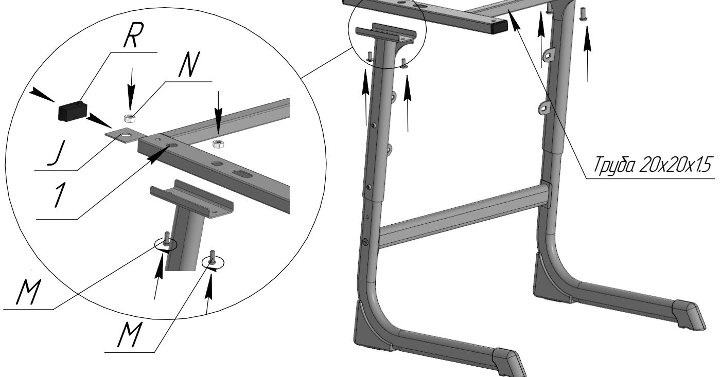
Пластину J установить внутрь трубы, совместив отверстие в пластине с отверстием 1 (см.схему). Затем установить заглушку R
