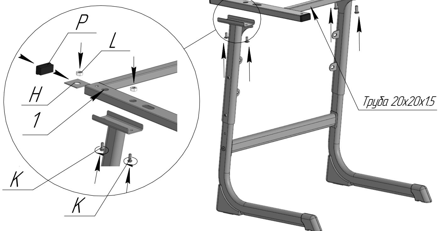
Пластину Н установить внутрь трубы, совместив отверстие в пластине с отверстием 1 (см.схему). Затем установить заглушку Р
