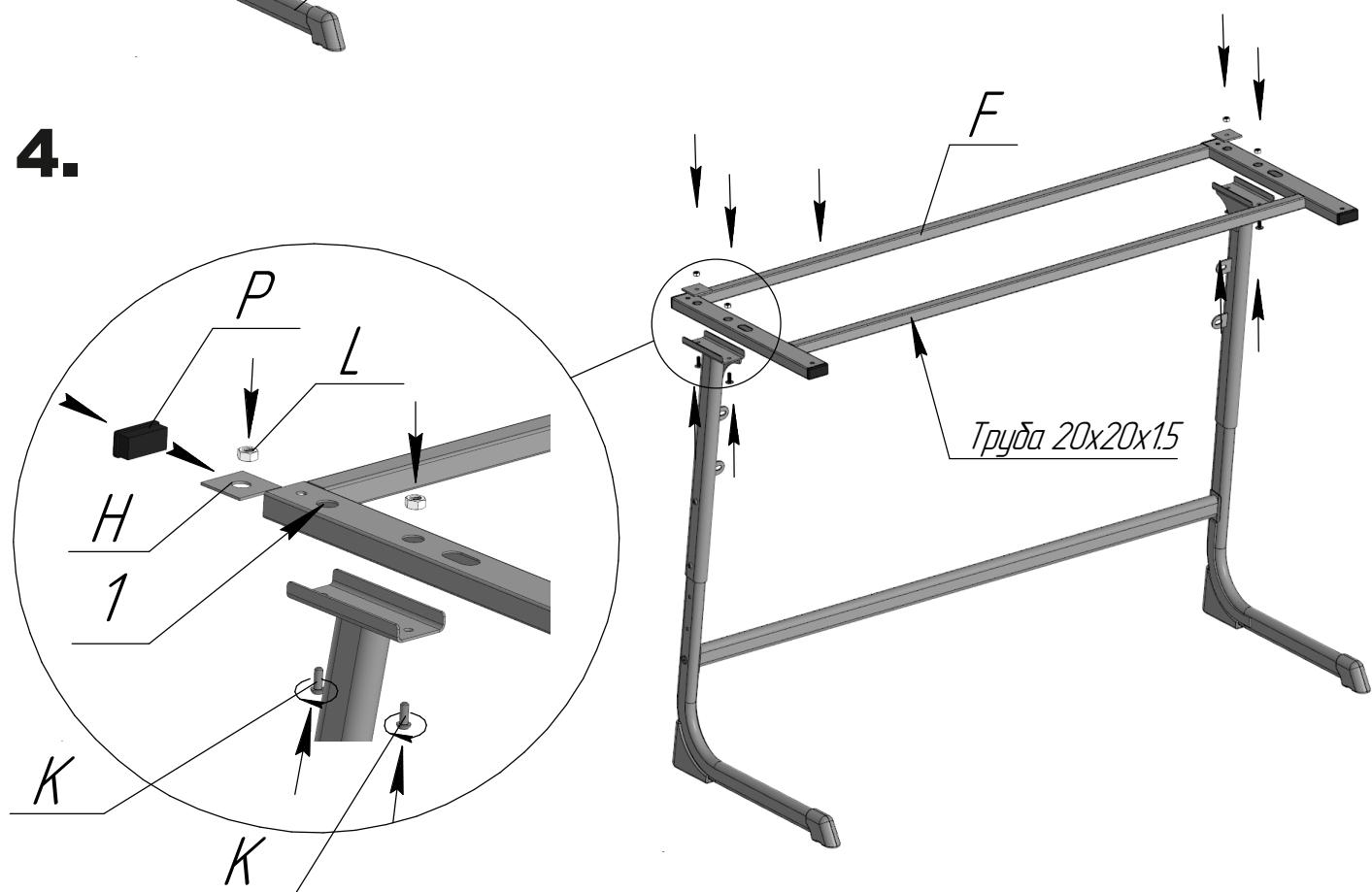
Пластину Н установить внутрь трубы, совместив отверстие в пластине с отверстием 1 (см.схему). Затем установить заглушку Р
