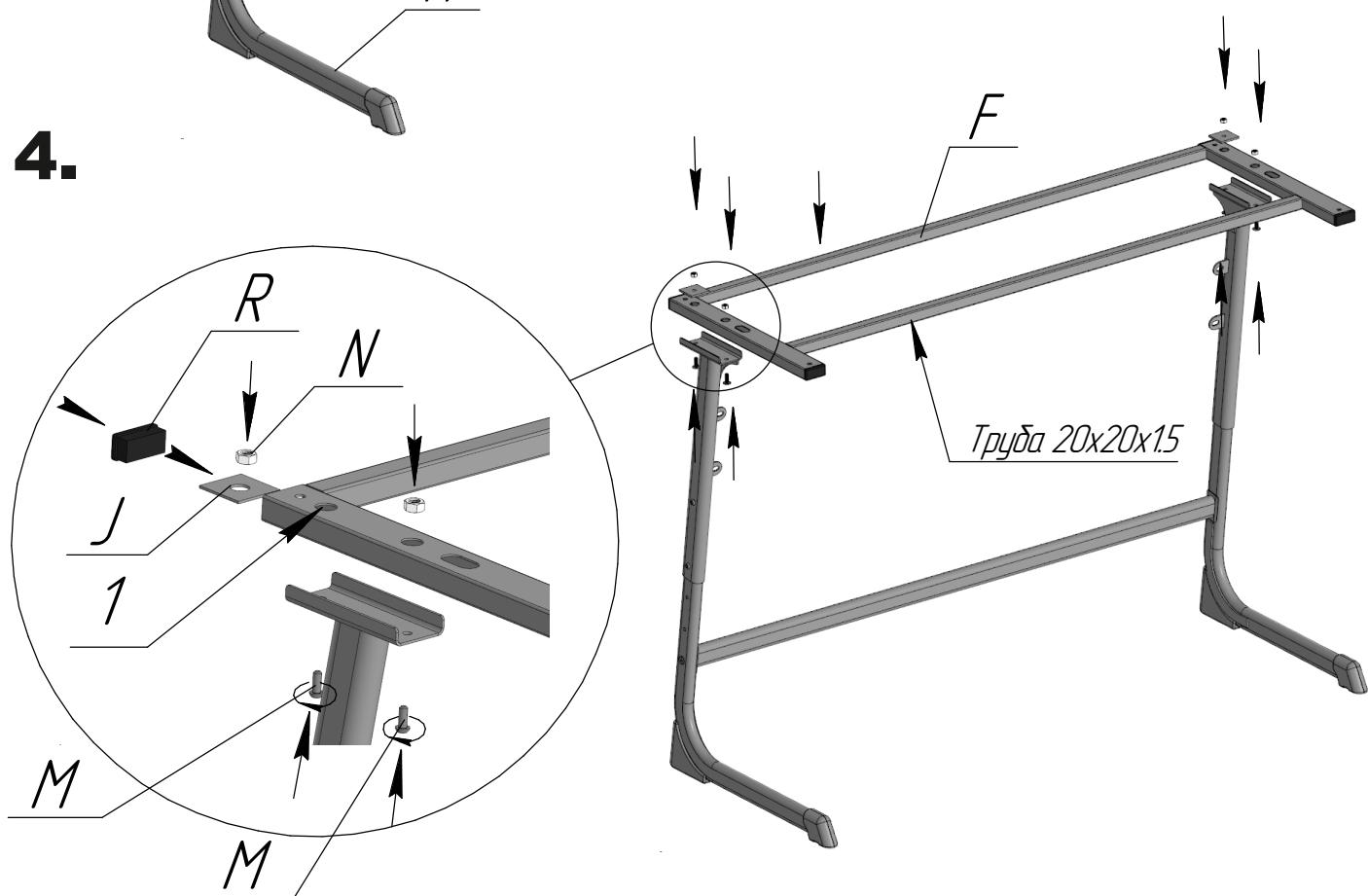
Пластину *J* установить внутрь трубы, совместив отверстие в пластине с отверстием *1* (см.схему). Затем установить заглушку *R*
